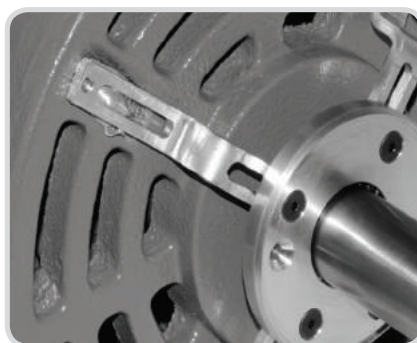
Installazione della resina epossidica conduttiva AEGIS® EP2400
